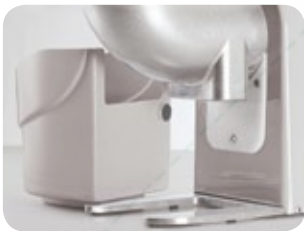
收集槽带安全微限开关
